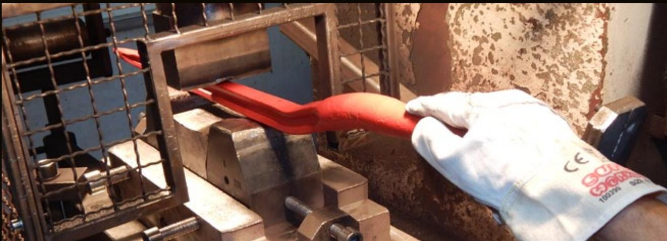
Jeder Zinke wird gerade gerichtet und unterliegt hierdurch einer 100% Qualitätskontrolle
